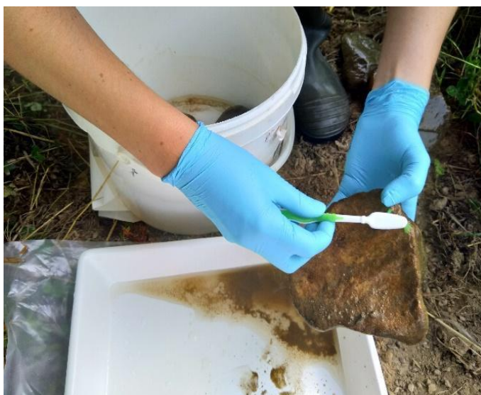
Fig. 4. Fiume Bistrice, campionamento del biofilm con spazzolino sterile e guanti.
