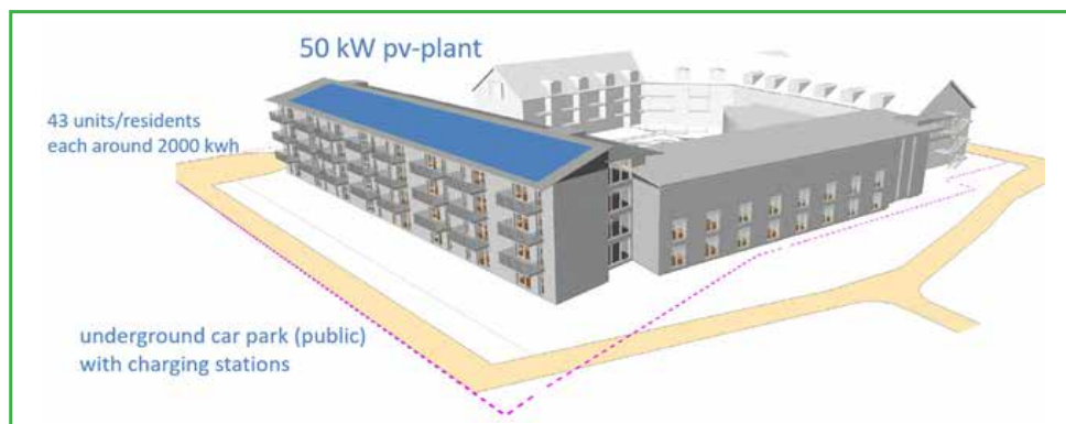
Abbildung 13 – Neues Seniorenheim mit einer 50 kW PV-Anlage, Mieterstrommodell für 43 Wohneinheiten und eine öffentliche Tiefgarage mit Lademöglichkeiten für Elektroautos
